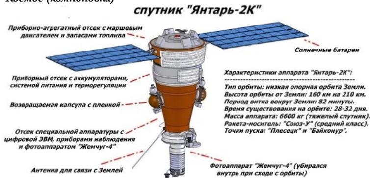
Рис. 1. Компоновочная схема КА «Янтарь»
