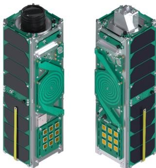
*Рисунок 2. Общий вид МКА PPTM 3U с дополнительной аппаратурой ОЭН и АИС*
