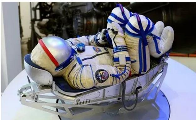
При отказе работы ДМП перегрузка на днище корабля может достигать 75 ед; при этом, благодаря полному ходу амортизатора и сминанию пенополиуретана в ложементе ( $\approx 30\dots 40$  мм), перегрузка на кресле снижается до 25 ед., что для космонавта переносимо, хотя и не исключены травмы.
